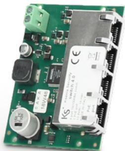
switch 4.0 est un commutateur réseau 10 / 100Mbit conçu pour connecter les centrales lars 4.0 avec les modules IP (ergo-T / ergo-T plus, gemino IoT, porta, etc.) de Ksenia Security. Il dispose de 4 ports réseau dont un PoE (Power over Ethernet) qui peuvent être utilisés pour connecter directement un module IP.
