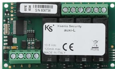
**auxi-L** ist eine Erweiterungsplatine mit 5 Relaisausgängen für 250V-8A (10A Spitzenstrom) mit einem gemeinsamen Wechselschalter, der ideal für die Beleuchtungssteuerung und das Abtrennen der Lasten geeignet ist.
