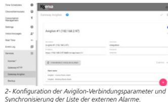
2- Konfiguration der Avigilon-Verbindungsparameter und Synchronisierung der Liste der externen Alarme.
