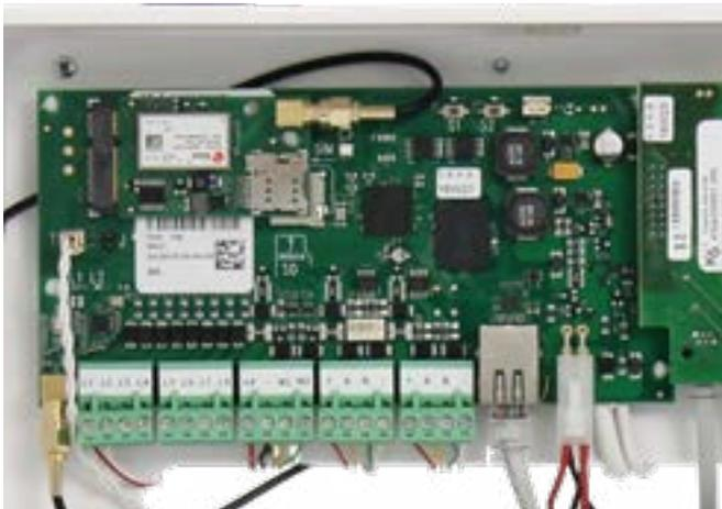
Infine, la porta di rete rappresenta il miglior mezzo per ampliare le funzioni della centrale: comunicazione remota mediante il gemino IoT con modulo 4G-LTE, controllo utente mediante le tastiere della serie ergo-T, integrazione con sistemi di terze parti.
