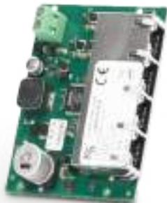
switch 4.0 ist ein Netzwerk-Switch 10/100 Mbit, der für die Verbindung der Steuerzentralen lares 4.0 mit den Touchscreen-Tastaturen ergo-T und ergo-T pro bestimmt ist. Er verfügt über 4 Netzanschlüsse, davon einen PoE (Power over Ethernet), der auch zum direkten Anschluss an eine ergo-T- oder ergo-T-pro-Tastatur verwendet werden kann. Das Gerät wird direkt über die Stromversorgung der Steuerzentrale gespeist und garantiert daher ein PoE-Backup für die Stromversorgung der Tastatur.
