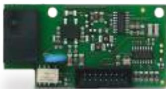
Mit dem TLF-Linie-Zusatzmodul kann die Kommunikationskapazität der Steuerzentrale lares 4.0 erweitert werden.
